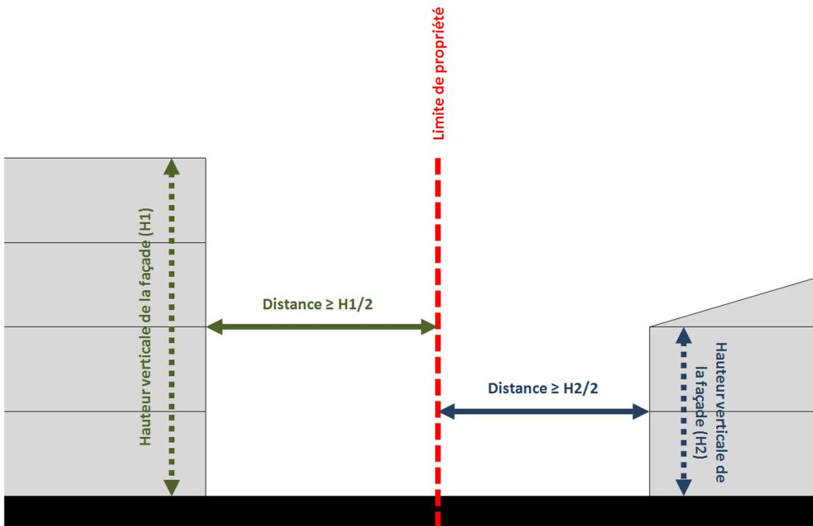
**Schéma n°5 : Règles de hauteur (calcul du niveau moyen du terrain (moyenne arithmétique des altimétries des sommets du polygone délimitant l'emprise de la construction)**
